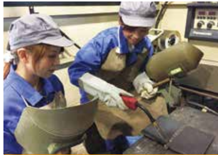
炭酸ガスアーク溶接作業
