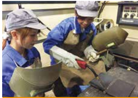
炭酸ガスアーク溶接作業
