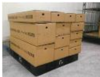
○ T11パレットに4種類の切り花標準箱を積み上げた様子
