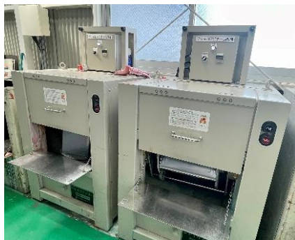
塗料缶を回転させて混ぜる機械
