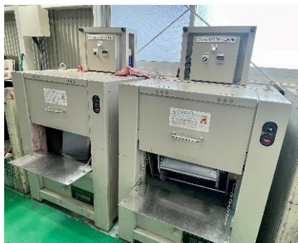
塗料缶を回転させて混ぜる機械
