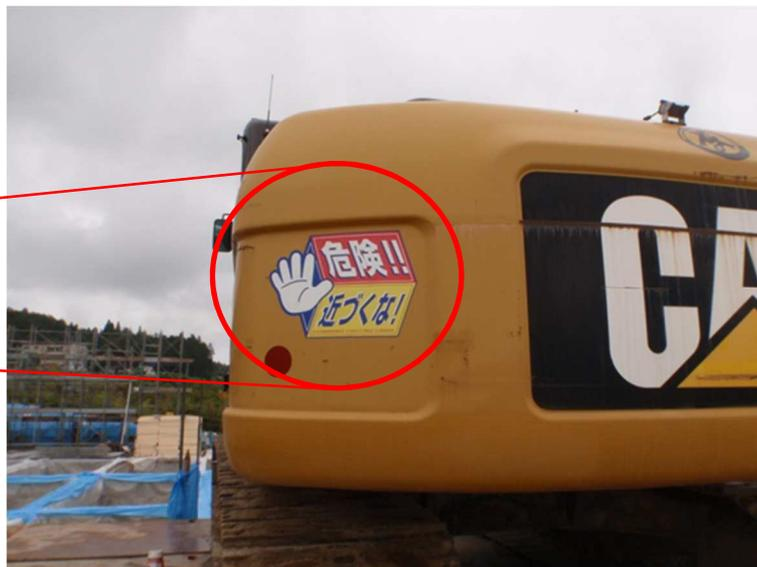
事例の概要 オペレータからの死角箇所にステッカーを明示して近接者への注意喚起を行っております。
