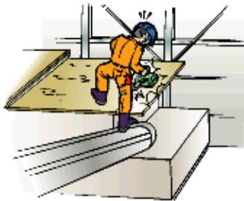
作業開始前に、携帯用丸のこ盤の歯の接触予防装置の機能を確保しましょう。携帯用研削盤(ディスクグラインダ)については、正規な砥石を装着しましょう。のこ刃の使用は禁止です。
