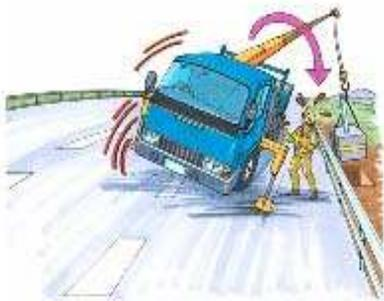
積載型トラッククレーンは、旋回方向により車両の安定が変わります。アウトリガの張出幅によっても定格総荷重が変わります。取扱説明書で確認しましょう。
