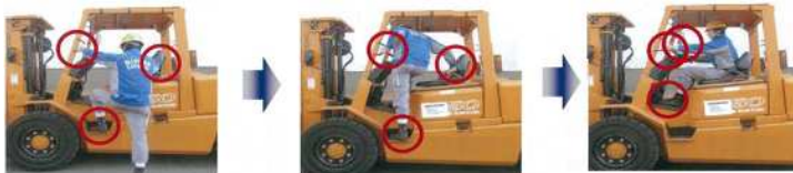
災害事例：足を踏み外して転落（骨折）
