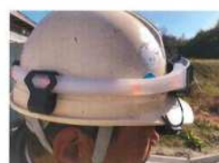
赤ライト点滅 バックホウオペレーターがどの作業員が侵入してきたか識別
