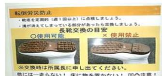
靴底の摩耗による転倒防止のため、分かりやすく写真を添え、長靴の交換目安を周知し、注意喚起を行っている。
