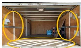
荷台内での転倒防止のため、作業エリアの制限をラインで区画し、「注意・危険エリア」とし、注意喚起を行っている。
