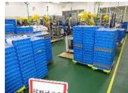
生産現場ではロボットが稼働していますが、労働者との接触防止の柵が設置されています。稼働状況がわかるランプは、ロボットや資材があっても隠れない高さに設置されています。整理整頓も徹底されています。
