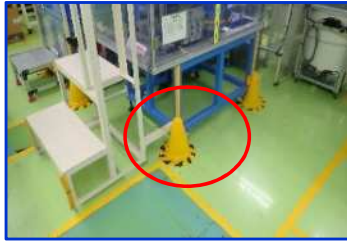
組立機地震対策固定版 躓き対策
