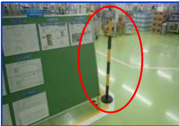
コーナーのショートカット防止対策 ポール設置
