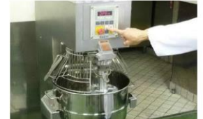
ホールド・トゥ・ラン制御装置（可動式覆いを閉じた状態のときでも、ボタンを押している間に限り、低速で回転する。）を有するミキサー
