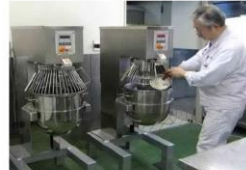
インターロック機構（可動式覆いを閉じないと回転部が動かない機能）を有するミキサー
