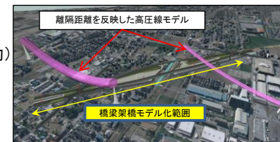
橋梁と架空線の離隔確認
