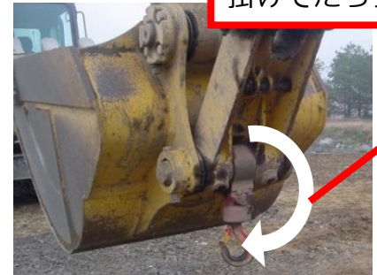
クレーン作業時 (フックを引き出す)
