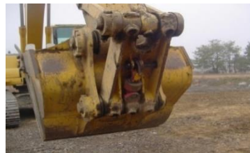
ショベル作業時 (格納されている)
