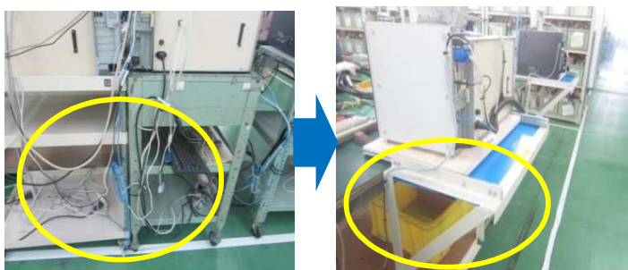
機械裏側の配線についてスライド式テーブルの作成と合わせて配線を整理
