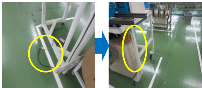
配線のたるみを作業台のフレームに固定
