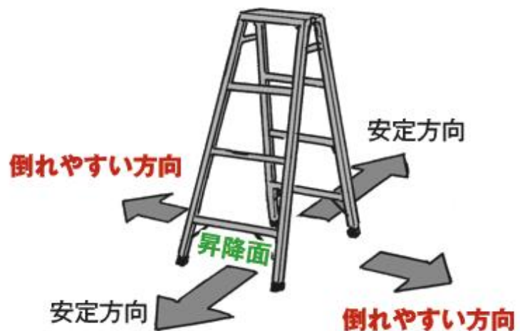
図3-26 脚立の安定方向と不安定方向
