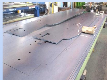
レーザー加工後に木槌を使って型抜きをします。比較的、簡単だそうです。
