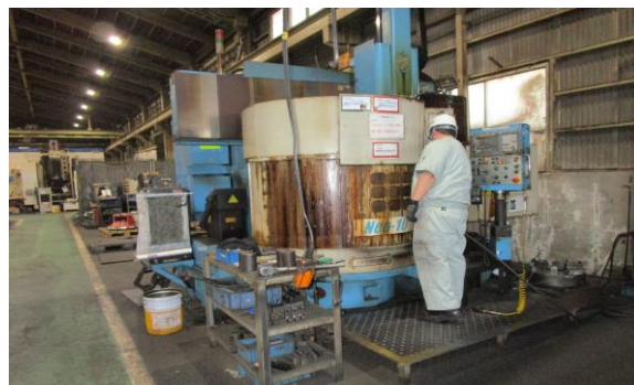
■NCターニングと操作する機械工
