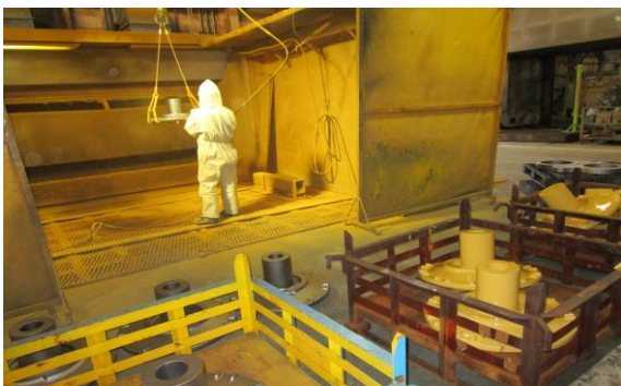
■塗装作業（建設機械部品）
