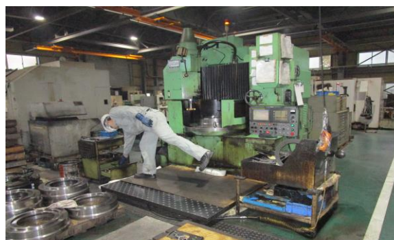
■歯切加工機と操作する機械工
