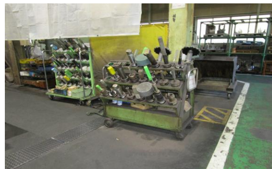
■NCマシニングセンタ機で使用する切削工具（刃）
