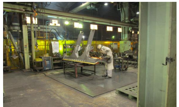
■溶接後の微調整作業（グラインダーがけ）
