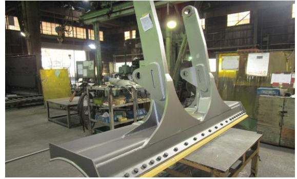
■加工後のブレード (土砂や雪を寄せるためにブルドーザー前につける)
