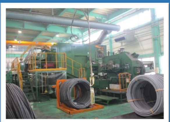
第7工場 主力設備である ボルトフォーマーによる冷間製法
