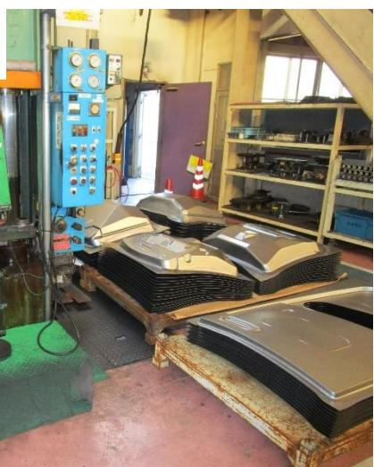
大型のプレス機に材料を投入します。
