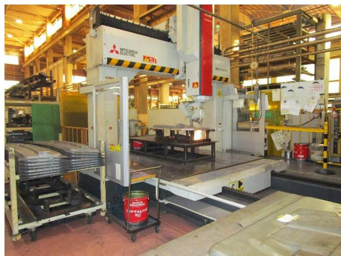
大型の自動溶接機を1人で操作します。
