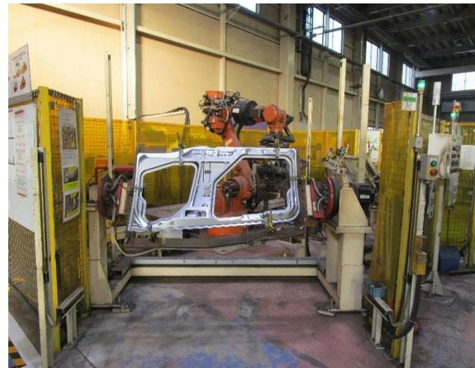
ロボットを用いてドアの形にします。
