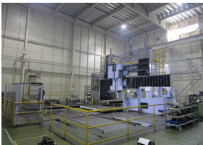
金属の各パーツに穴をあける作業 基本的に各機械に作業員が一人付く
