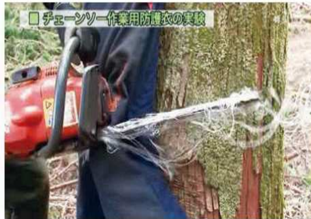
チェーンソー作業用防護衣の実験
