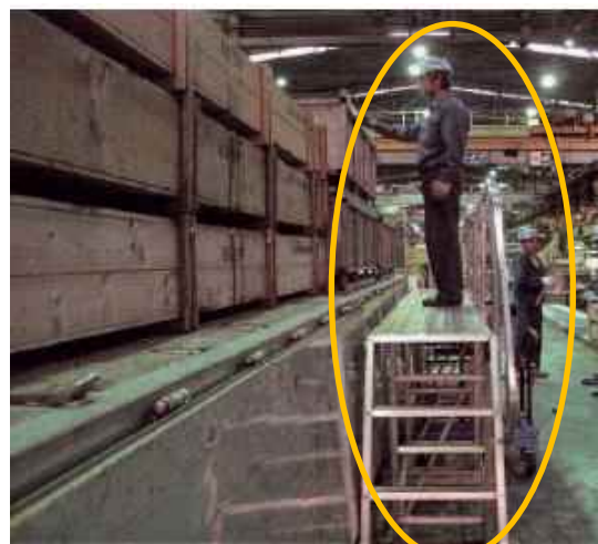
《墜落防止対策の事例》 昇降設備と作業台（手すり付き）の設置 「荷役作業を安全に」のリーフレットの抜粋
