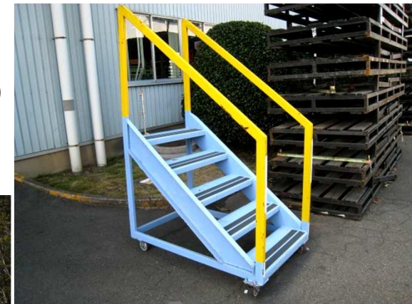
可搬式昇降設備の設置例(右)
