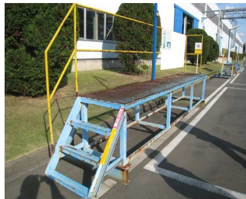
(左)屋外での荷締め専用場所の設置例。
