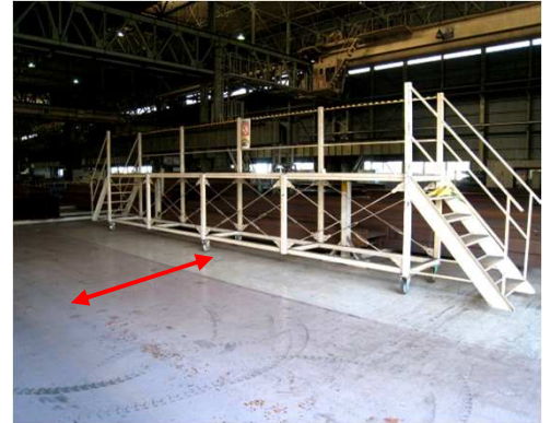
(上)キャスター付の移動式プラットフォームの設置例。プラットフォームごと幅寄せが可能。
