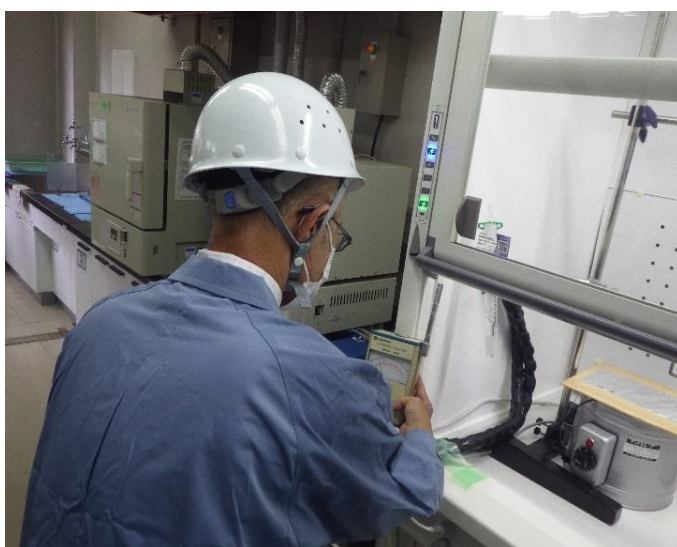
局所排気装置の風速を測定する山口署長
