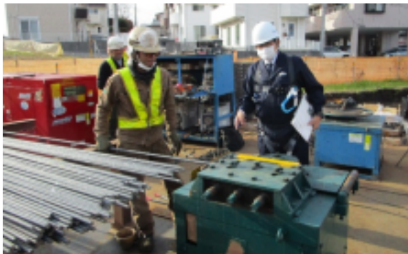
鉄筋を曲げる機械(ベンダー)操作の説明を受ける小室署長(右側)
