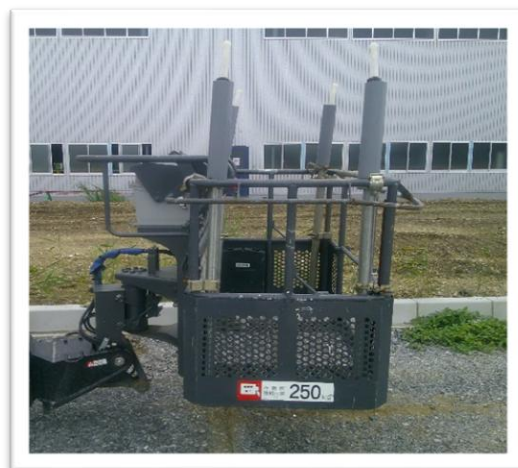
墜落防止措置の確認を行う奥山署長（中央） 高所作業車の作業床上部に設けられた検知装置
