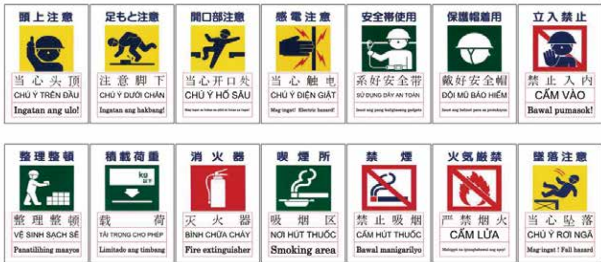
図 19 優良作品事例（安全標識の統一と外国語表記）〔戸田建設株式会社東京支店〕
