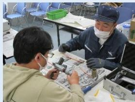
フレア加工ツールとトルクレンチを使用し、エアコンで使用されている銅管の接続を体験します。
