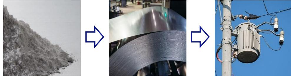
当社が製造する電磁鋼板用酸化マグネシウムは、鉄鋼メーカーにおいて電磁鋼板の製造時に焼鈍分離剤として使用されます。こうして作られた電磁鋼板は、送電線用変圧器に組み込まれ、工場や住宅へ電力を供給する役割を担っています。
