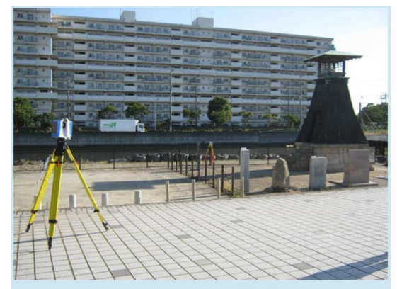
地上レーザ計測
