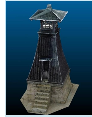
地上レーザ計測結果からのモデリング事例
