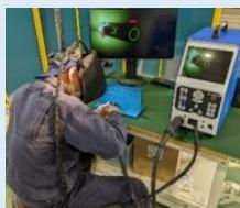
鉄骨鉄筋コンクリート造の鉄骨同士を繋ぐ際に使用される溶接作業を、AR溶接訓練シミュレーターを使用して体験します。
