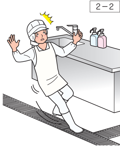
グレーチングで、転倒の危険
