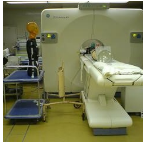
4) 線源から100 cm +3 cm鉛防護板
