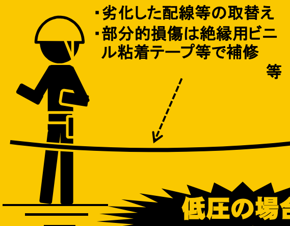
電路近接作業時等の対策例
