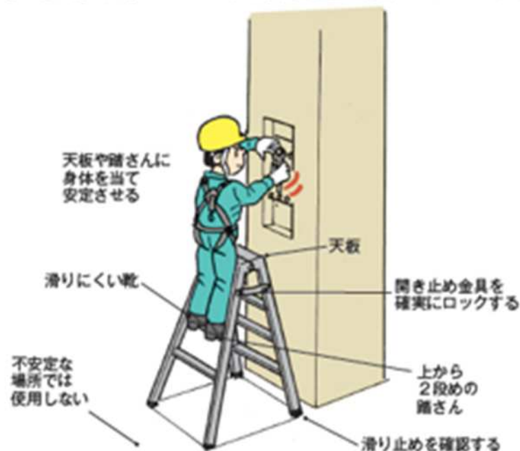
図3-15 脚立の正しい使い方
