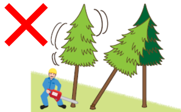
(図4)かかり木に激突させるためにかかり木以外の立木の伐倒
