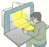
換気装置等を設置し稼働
