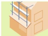
・本足場を使用することにより建築物等と足場の作業床との間隔<sup>※</sup>が広くなり、墜落・転落災害のリスクが高まる
