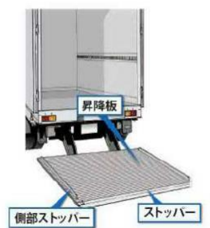
テールゲートリフターの例
