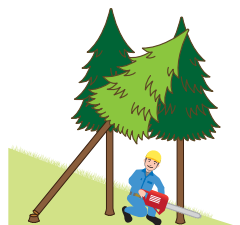
(図3) かかっている立木の伐倒
