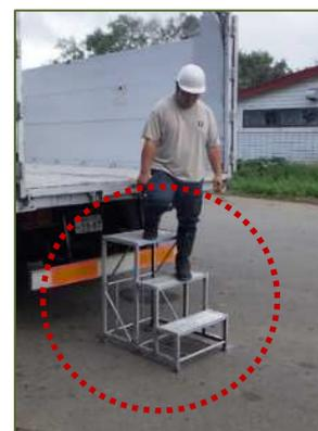
より安全な昇降のために、手すり付き昇降設備の使用も考えられます（P19参照）
