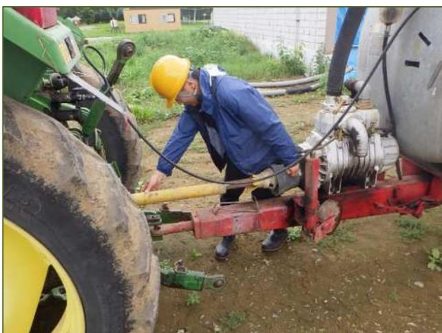
安全カバーが破損している
