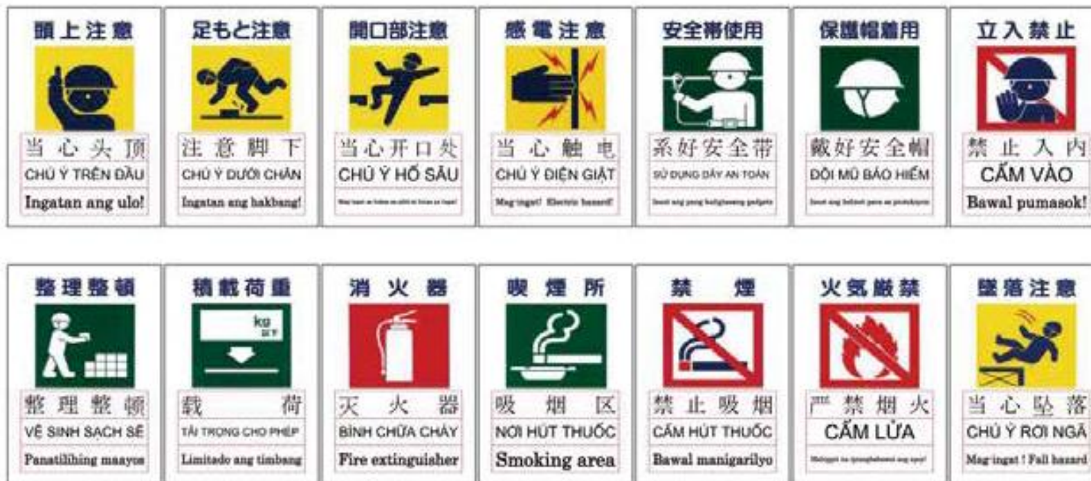
図 19 優良作品事例（安全標識の統一と外国語表記）〔戸田建設株式会社 東京支店〕
