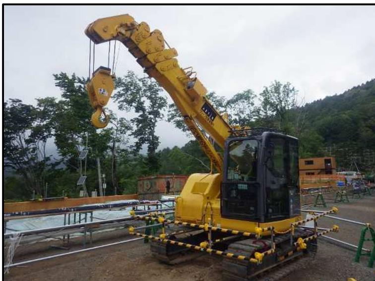
建設重機との接触防止措置としての塩ビ管が取り付けられている。
