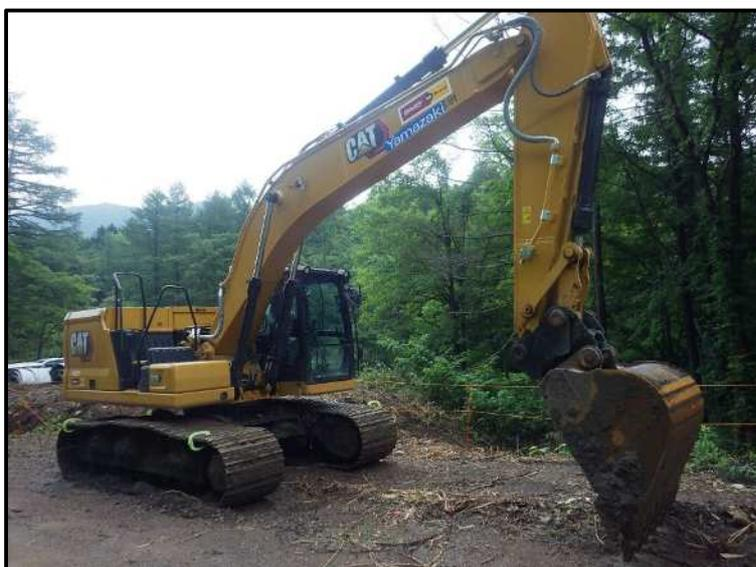
建設重機運転開始前に、キャタピラに設置された洗濯バサミを外しながら移動することで、建設重機周辺に作業員がいないことを確認することができるようになっている。
