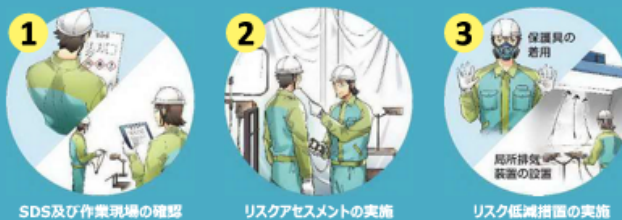
SDS及び作業現場の確認 リスクアセスメントの実施 リスク低減措置の実施
