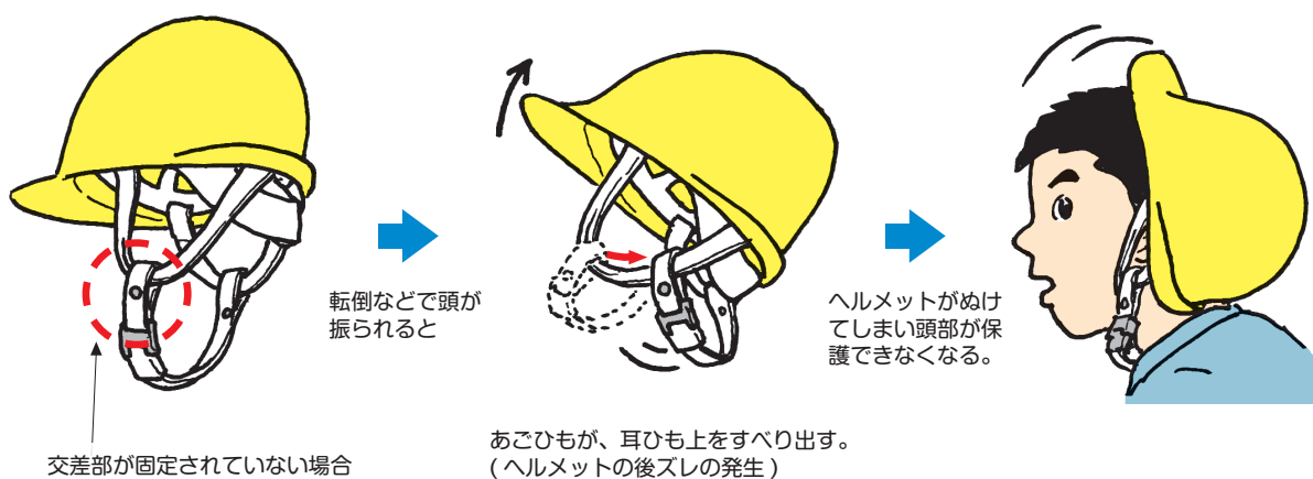
図4-23 あごひもが耳ひもに固定されていない場合
