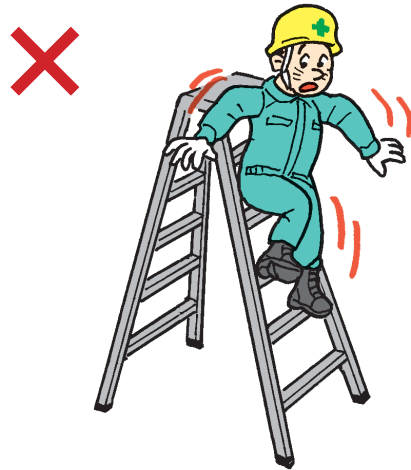
図3-30 昇降面に背を向けた危険な降り方
