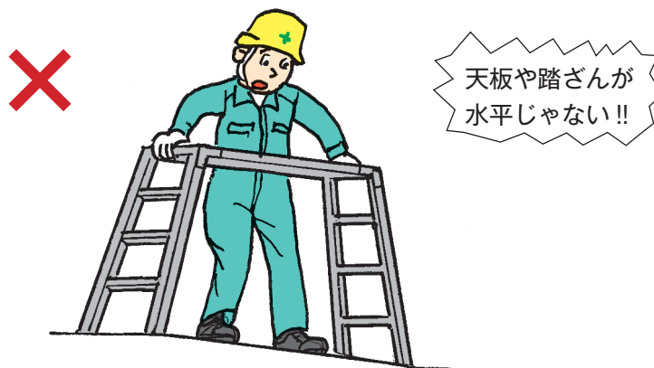
図3-32 軟弱地盤・傾斜地に設置しない
