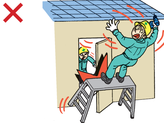
図3-36 ドアの前に設置しない
