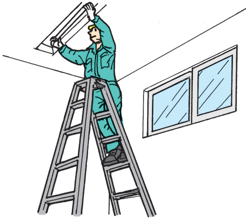
図3-23 脚立の正しい使い方
