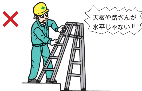
図3-22 天板が水平にならない場所には設置しない
