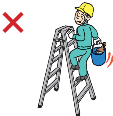
図3-27 片手が塞がった状態で昇降しない
