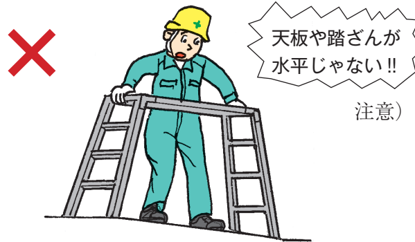
図3-37 天板が水平にならない場所に設置しない
