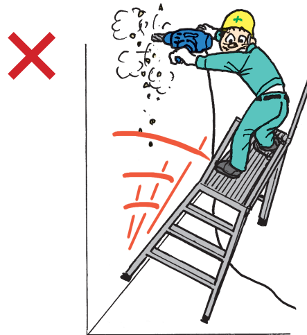
図3-39 力を入れる作業を行わない
