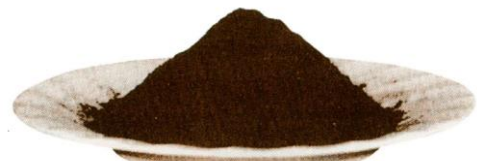
アーク溶接の煙の正体 (集じん機で捕集された溶接ヒューム)
