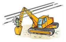
ドラグ・ショベルのバケット に乗り作業をしようとドラ グ・ショベルの用途外使用
