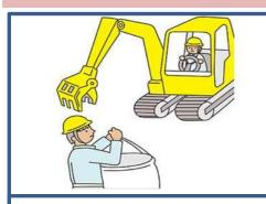
アタッチメントにフレコンバックの帯を引っ掛け、吊り上げようと解体用アタッチメントの用途外使用
